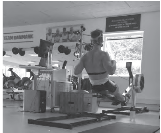
図9 6分間テストの様子。より水に近い感覚でテストを実施するために、エルゴメータをスライドに乗せて実施する
